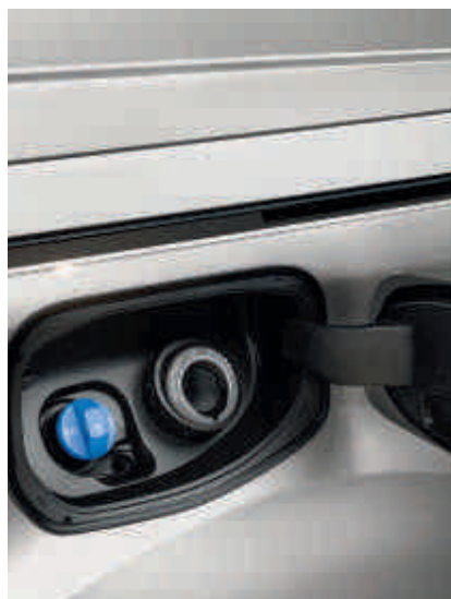
Sistema de repostaje sin tapón Easy Fuel de Ford (De serie)
