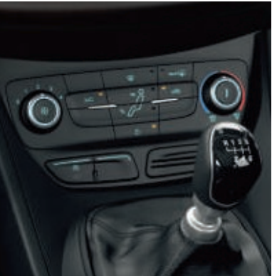
Aire acondicionado manual
