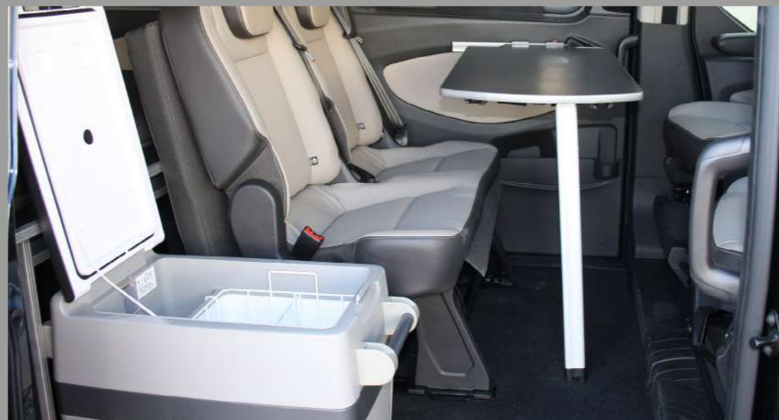
NEVERA COMPRESOR ANCLAJE FIJO
